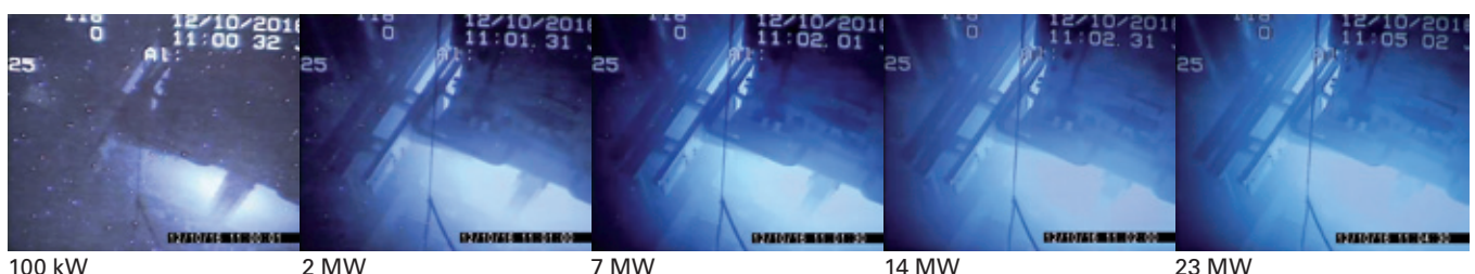
Photos de la piscine du réacteur montrant les caractéristiques de l'effet Cherenkov selon la puissance du cœur.
