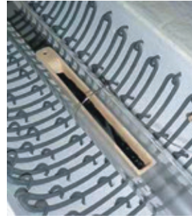
Le projet STEM: L'installation d'essai START (à gauche) et le creuset d'alumine (à droite) avec de la poudre de RuO 2 dans le tube de quartz.
