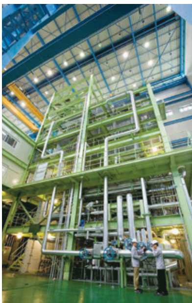
Vue de la boucle d'expérimentation ATLAS. KAERI, Corée
