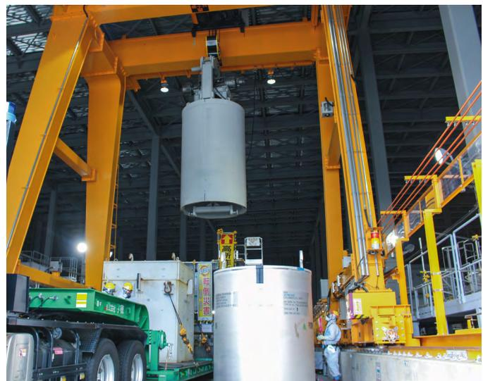
福島第一原子力発電所構内で発生する放射性物質を含む水を浄化する装置で使用された吸着剤の保存容器を取り扱う従事者。使用済み吸着剤は堅牢な容器に密封されて保管されている。写真提供：東京電力ホールディングス
