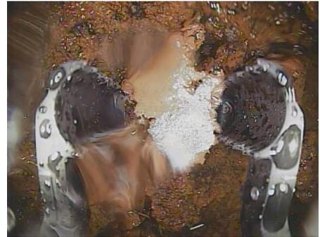
福島第一原子力発電所2号機原子炉建屋の内部、原子炉格納容器内にある燃料デブリ(原子炉内にあった燃料が事故で溶け、さまざまな構造物と混じりながら、冷えて固まった物質)の状態。フィンガー構造を持つ機器によって動かすことができることが確認された。写真提供:東京電力ホールディングス
