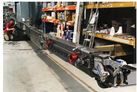
福島第一原子力発電所2号機原子炉格納容器内にある燃料デブリの試験的取り出しに用いる装置のロボットアーム部分。英国で開発され、日本に輸送した後、性能の確認や現場を模擬したモックアップでオペレータのトレーニングなどを行い使用される予定。写真提供:国際廃炉研究開発機構(IRID)
