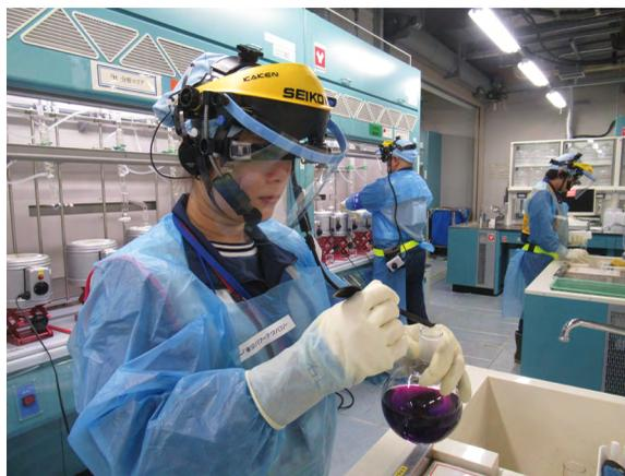
福島第一原子力発電所及び周辺で採取された試料を対象に、放射能濃度や水質の分析を行う従事者。頭部に装着しているのはスマートグラスと呼ばれる作業支援装置で、データ入力や確認作業の生産性と品質の向上を達成している。写真提供:東京電力ホールディングス
