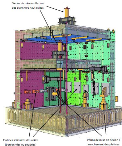
Vue en perspective de la maquette SAM et des équipements d'essais associés
